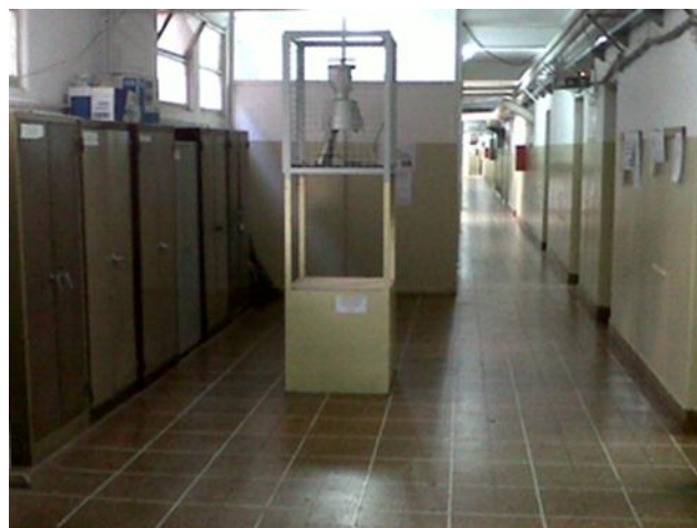
Figura 3: captador aerobiológico situado en el interior del edificio de la UNSL
